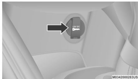
12 Volt Power Outlet
